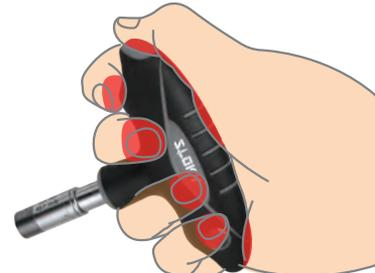
Der T - Handgriff wird benötigt, wenn besonders hohe Drehmomente zu Lösen oder Festziehen sind.
