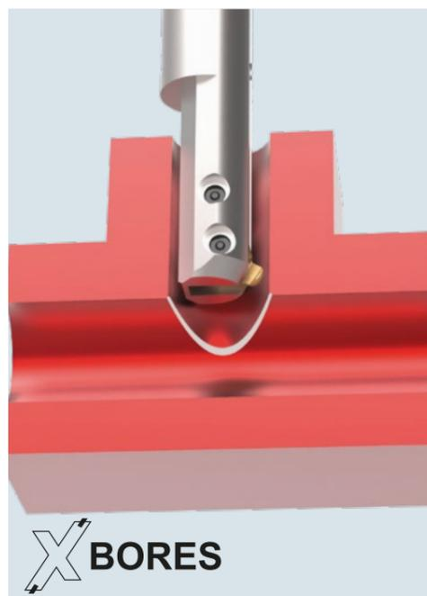
**COFA-X – Mechanisches Entgraten von 1:1 Querbohrungen.**
